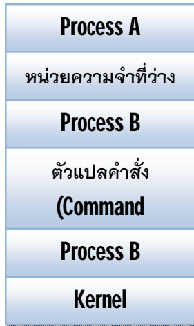
ภาพที่ 3.3 แสดงการทำงานของ UNIX
